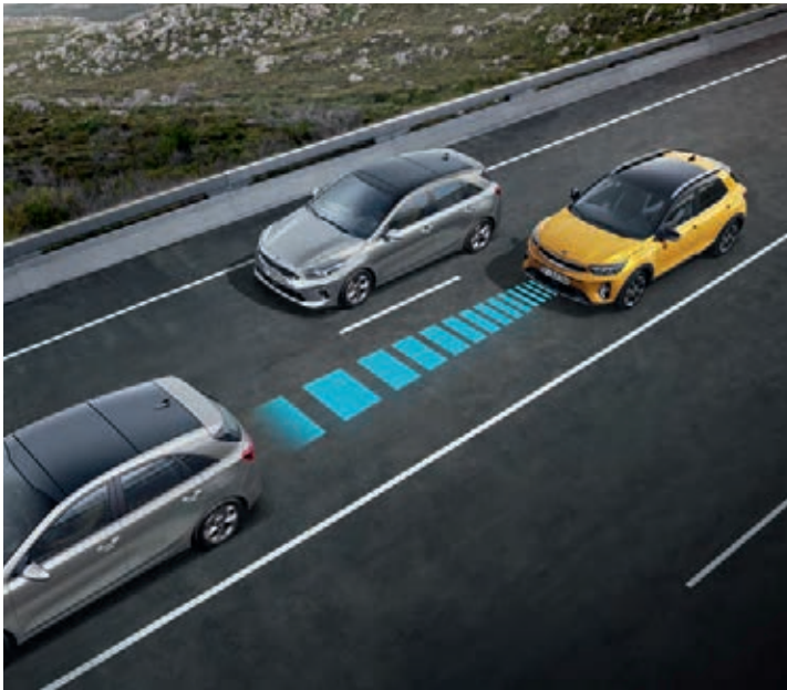
Querverkehrwarner A+ zur Erkennung von Fahrzeugen im toten Winkel beim Querausparken
