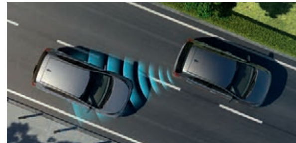
Spurwechselassistent mit Totwinkelwarner AA . Mithilfe von Radarsensoren erkennt das BCW-System (Blind-Spot Collision Warning) herannahende Fahrzeuge im Bereich des toten Winkels und warnt dich bei Bedarf optisch und akustisch davor, die Fahrspur zu wechseln. Solltest du es dennoch versuchen, erfolgt bei den Ausführungen mit AMT-Getriebe automatisch ein Lenk- und Bremsengriff, um eine Kollision zu vermeiden.
