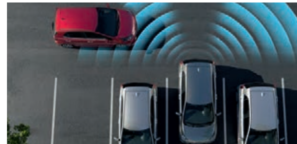
Querverkehrwarner AA . Beim Zurücksetzen aus Parklücken oder Einfahrten warnt dich der Querverkehrwarner (Rear Cross-Traffic Collision Warning, RCCW) durch optische und akustische Signale vor Fahrzeugen, die deinen Weg kreuzen. Bei den Ausführungen mit AMT-Getriebe erfolgt zudem automatisch ein Bremsengriff, wenn die Notbremsfunktion aktiviert ist.
